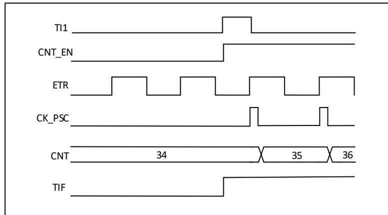
图 20-48 外部时钟模式 2 + 触发模式下的控制电路
