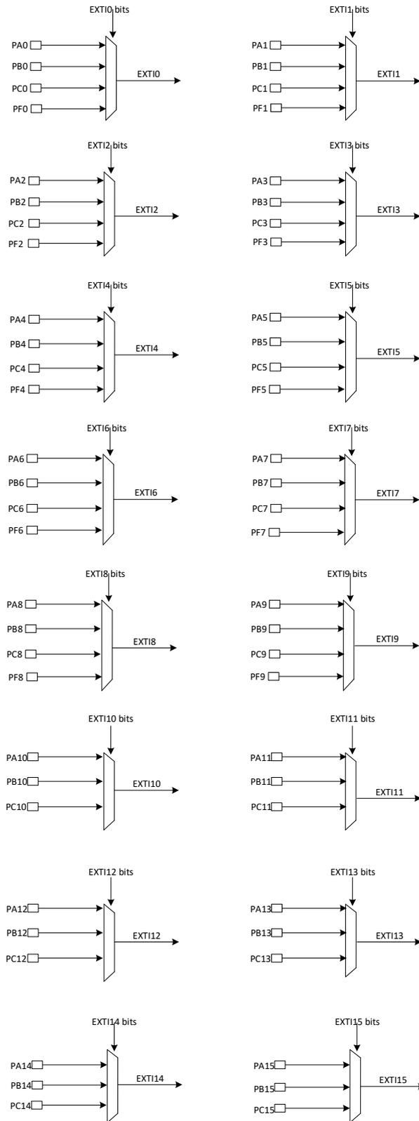
图 13-2 外部中断/事件 GPIO 映像
