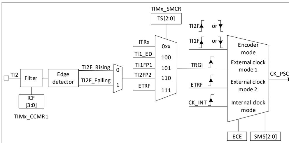
图 20-23 TI2 外部时钟连接例子
