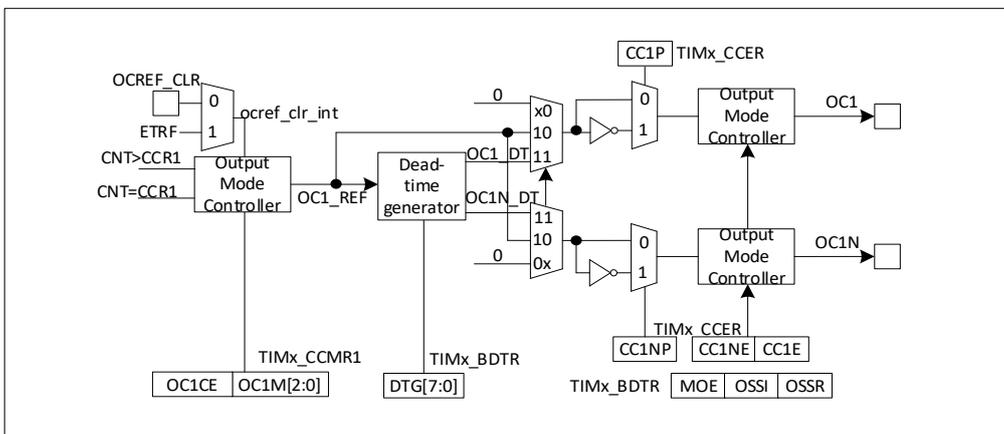
图 20-29 捕获/比较通道的输出部分 (通道 1 至 3)
