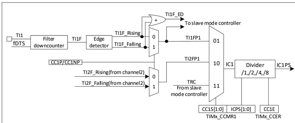
图 20-27 捕获/比较通道 (如: 通道 1 输入部分)
