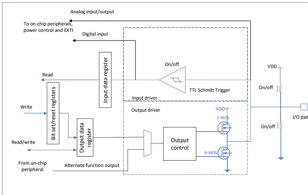
图 10-1 IO 端口位的基本结构
