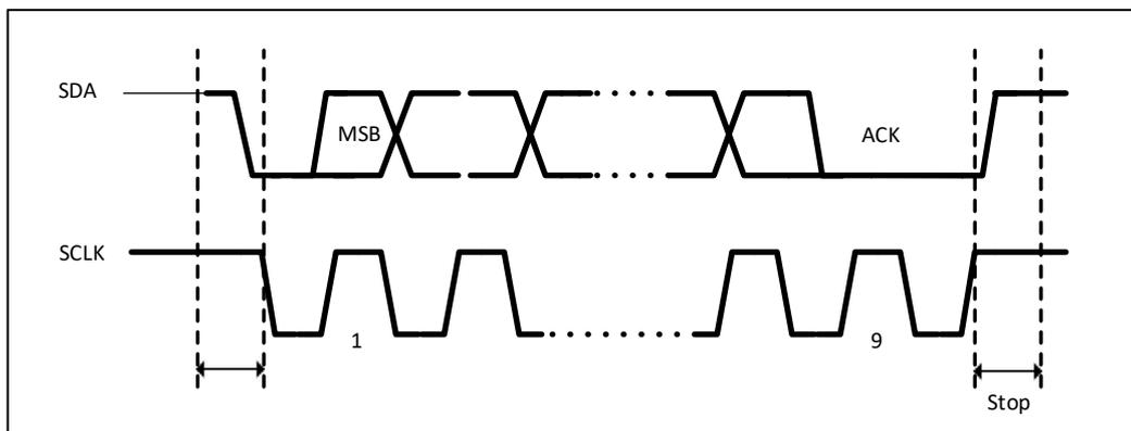
图 29-2 I<sup>2</sup>C 总线协议
