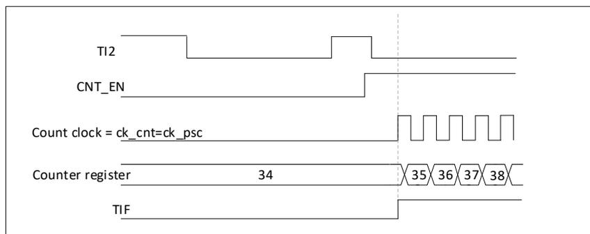
图 24-33 门控模式下的控制电路
