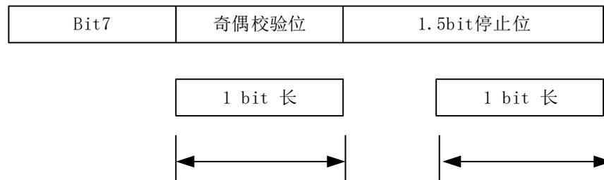
图 31-17 使用1.5停止位检测奇偶校验错
