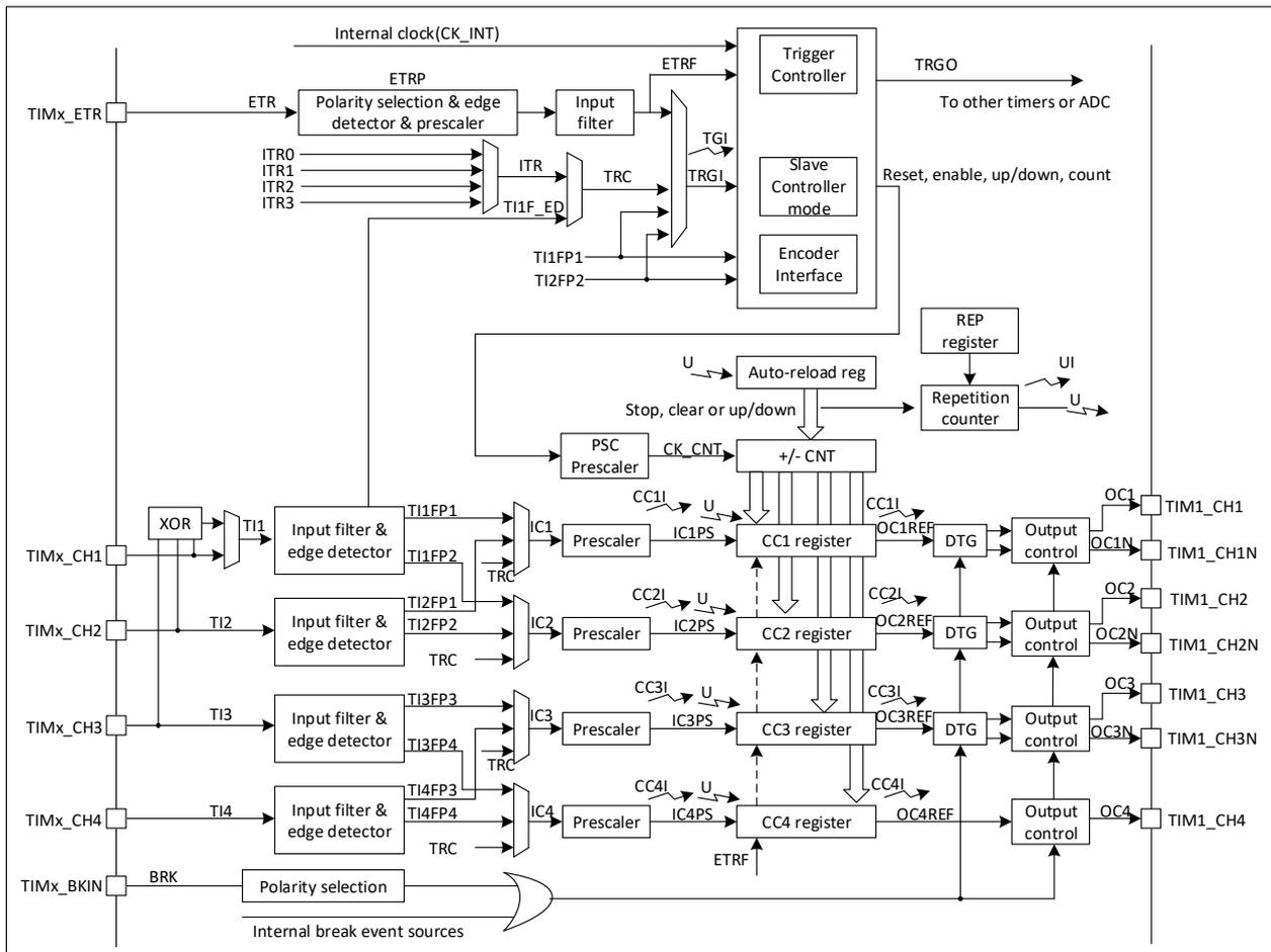
图 20-1 高级控制定时器架构框图
