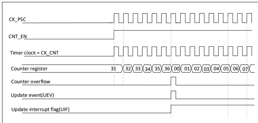
图 24-9 计数器时序图，当 ARPE=0 时的更新事件 (TIMx\_ARR 没有预装入)
