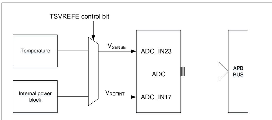
图 15-5 温度传感器通道框图
