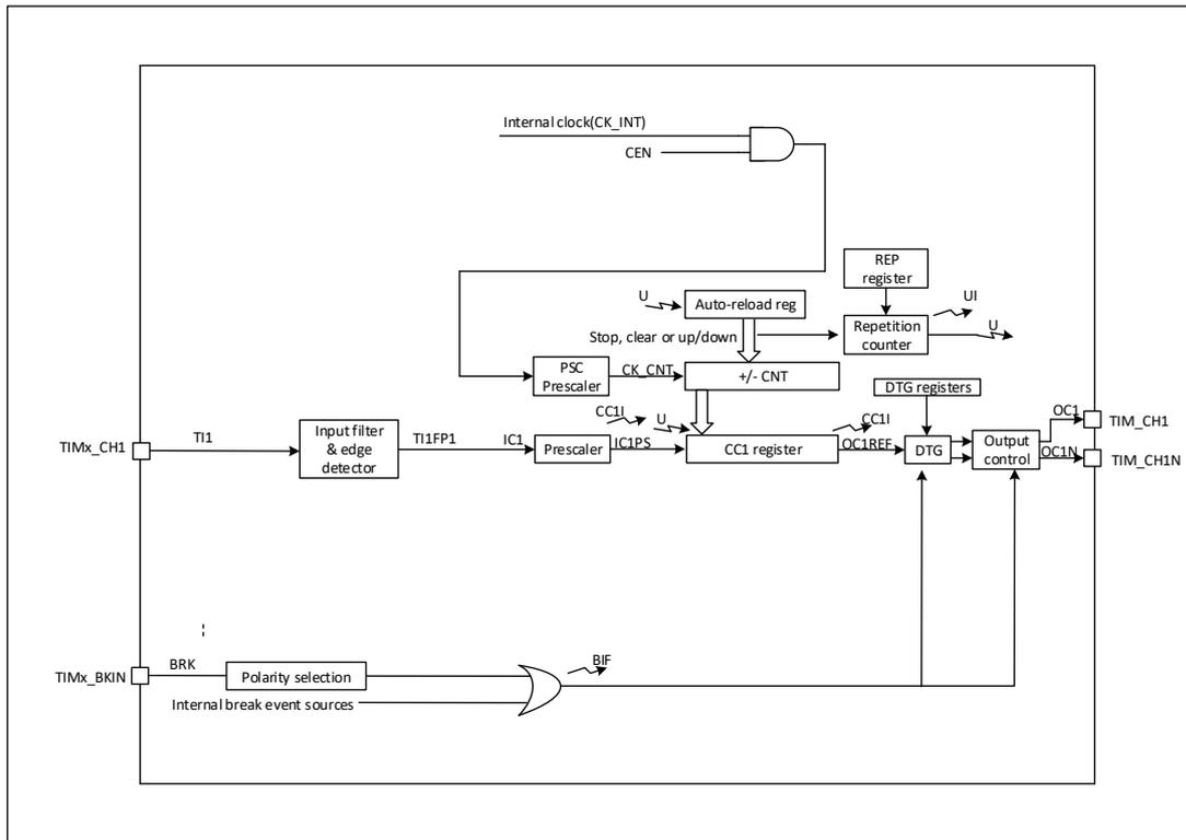
图 24-2 通用控制定时器 (TIM16\_17) 架构框图
