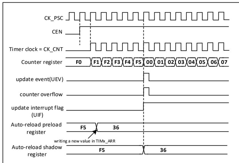
图 21-9 计数器时序图，当 ARPE=1 时的更新事件（预装入了 TIMx\_ARR）
