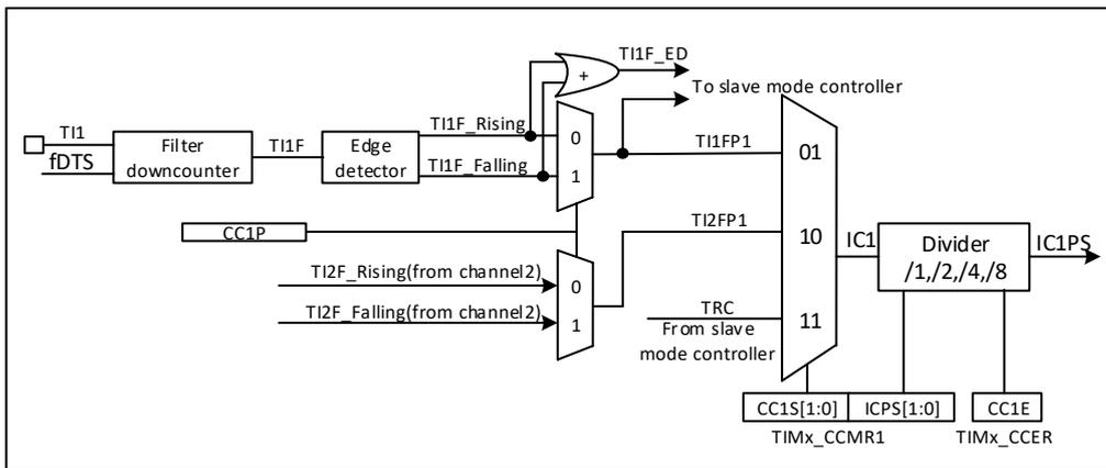
图 24-15 捕获/比较通道 (如: 通道 1 输入部分)
