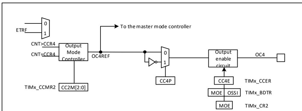
图 24-18 捕获/比较通道的输出部分（通道 4）
