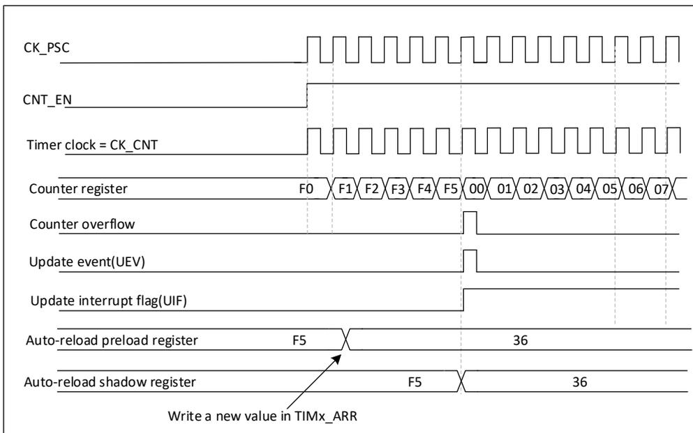
图 22-9 计数器时序图，当 ARPE=1 时的更新事件 (预装入了 TIMx\_ARR)
