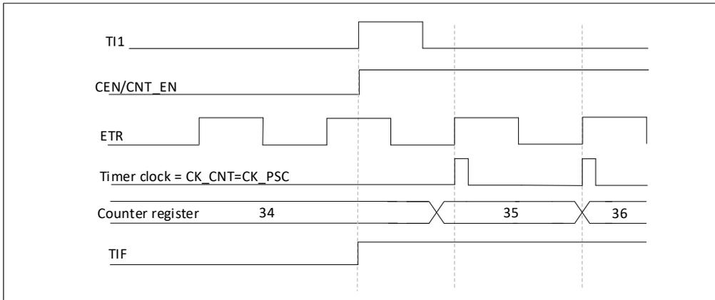
图 24-34 外部时钟模式 2 + 触发模式下的控制电路
