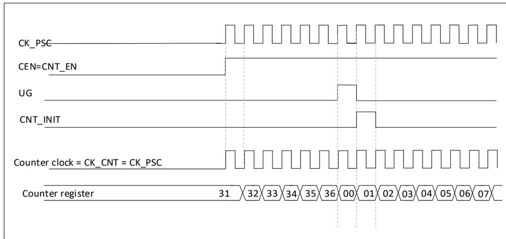
图 24-12 一般模式下的控制电路，内部时钟分频因子为 1
