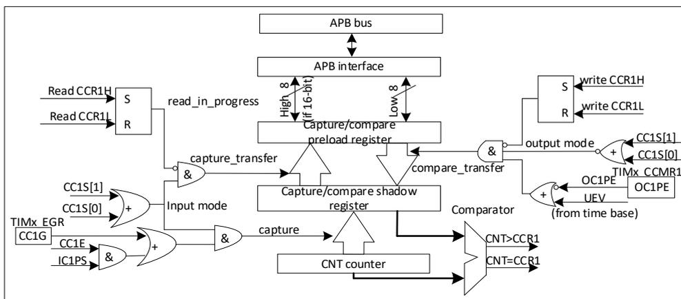
图 24-16 捕获/比较通道 1 的主电路
