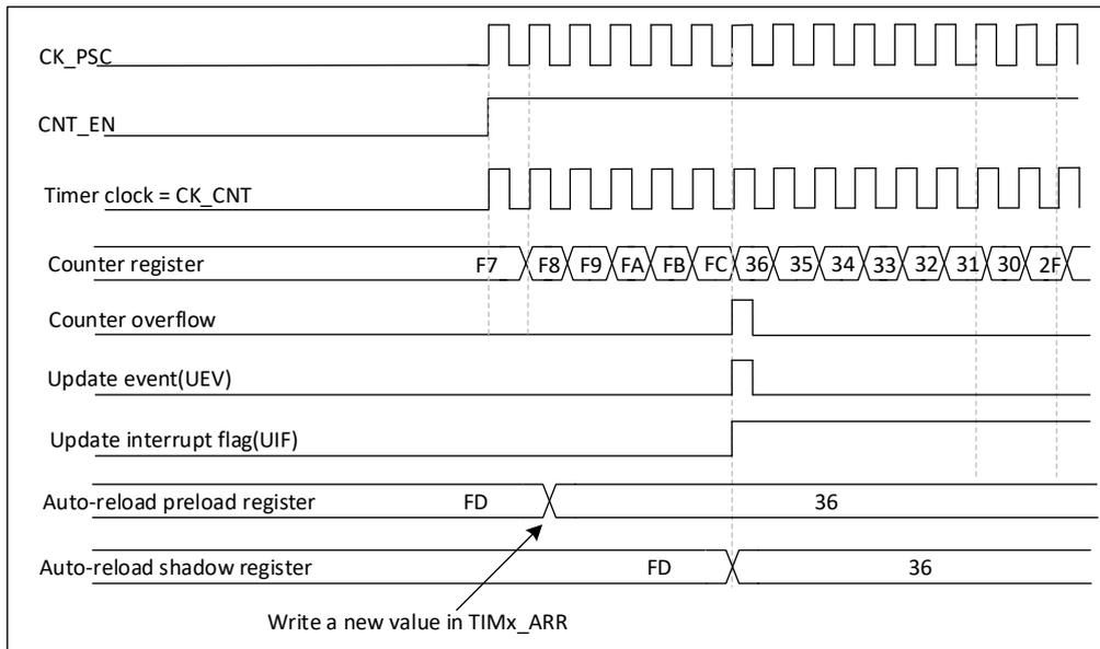
图 20-20 计数器时序图, ARPE=1 时的更新事件 (计数器上溢)
