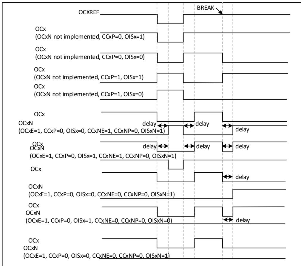
图 24-25 响应刹车的输出
