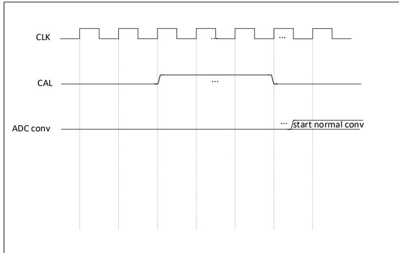
图 15-2 ADC 校准时序图
