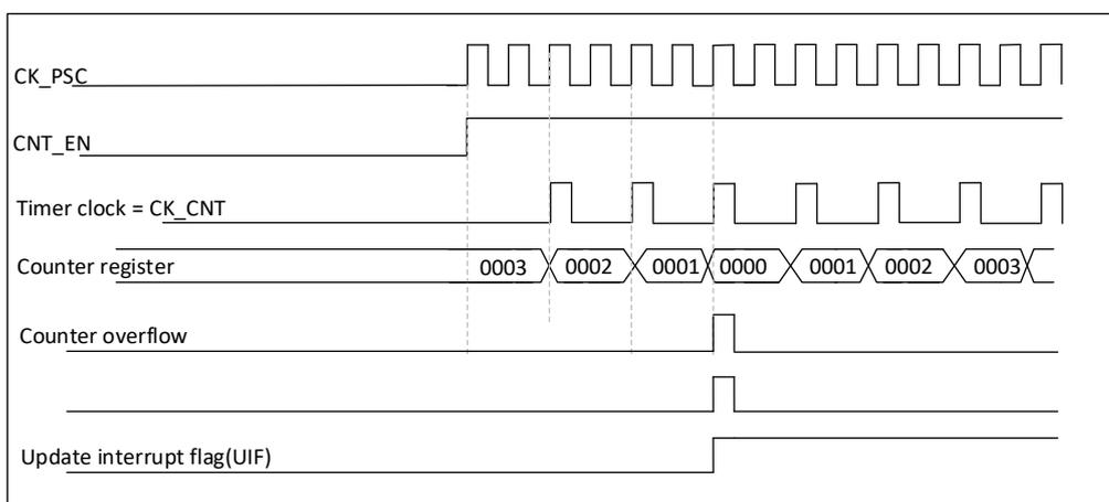
图 20-16 计数器时序图，内部时钟分频因子为 2，TIMx\_ARR=0x36
