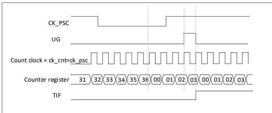
图 24-31 复位模式下的控制电路
