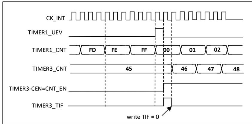
图 24-38 使用定时器1的更新触发定时器2
