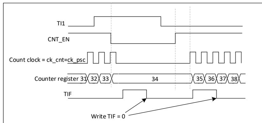
图 20-46 门控模式下的控制电路
