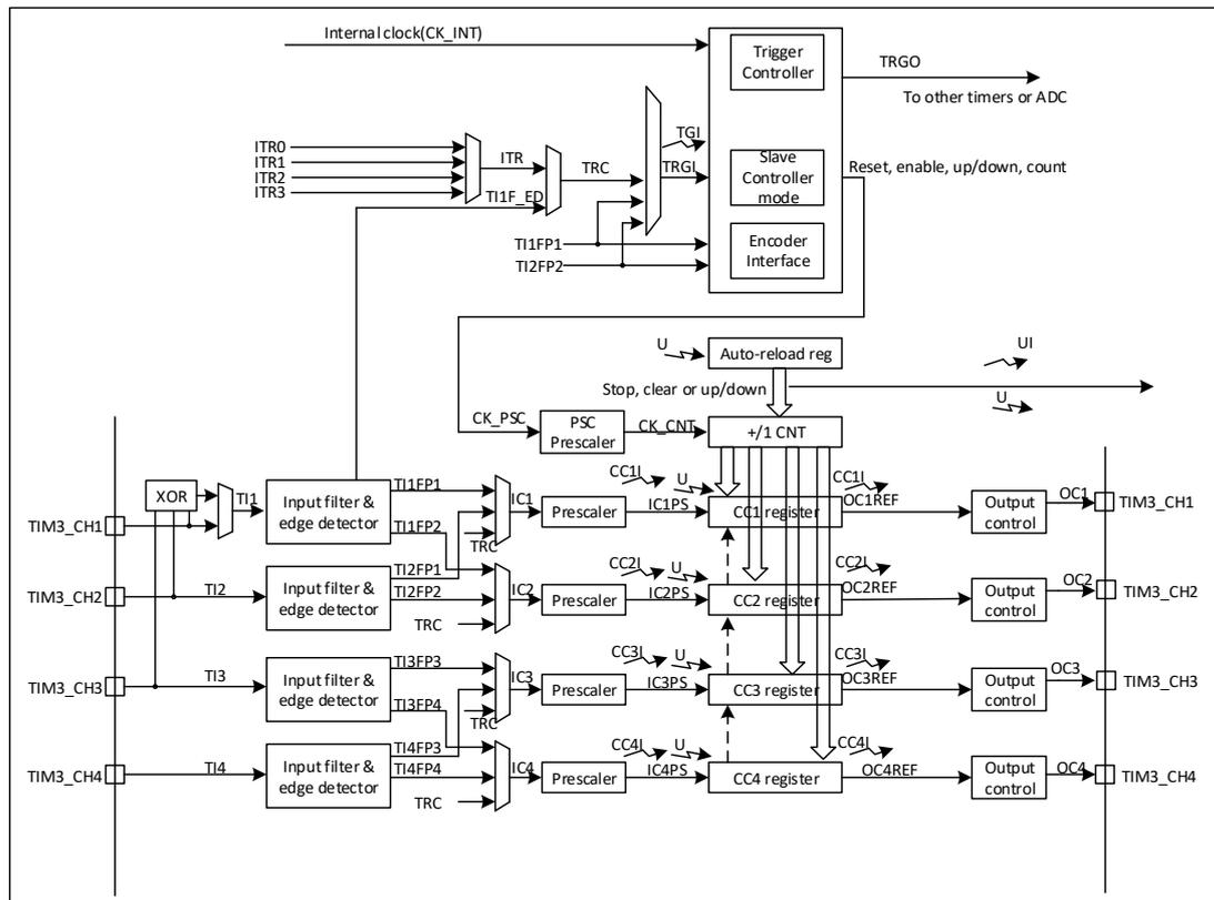
图 21-1 通用定时器架构图
