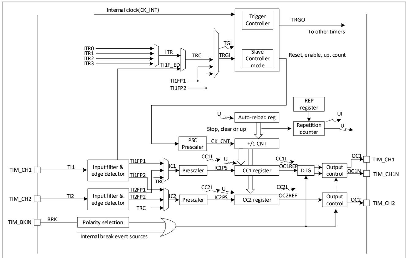
图 24-1 通用控制定时器 (TMI15) 架构框图
