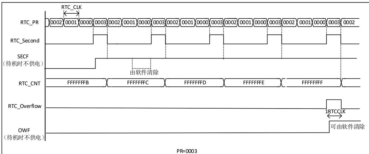
图 28-3 RTC 溢出波形图示例, PR=0003
