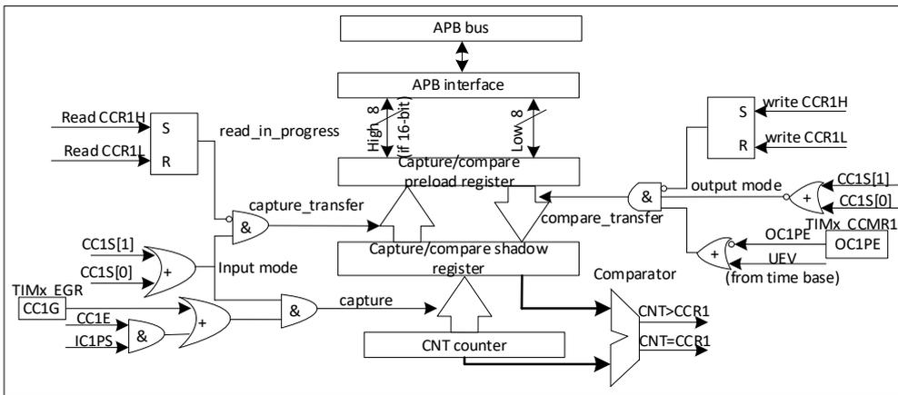
图 20-28 捕获/比较通道 1 的主电路
