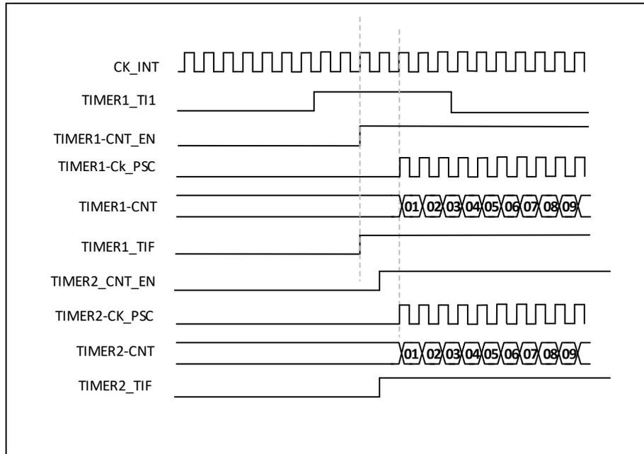
图 24-40 使用定时器1的 TI1输入触发定时器1和定时器2
