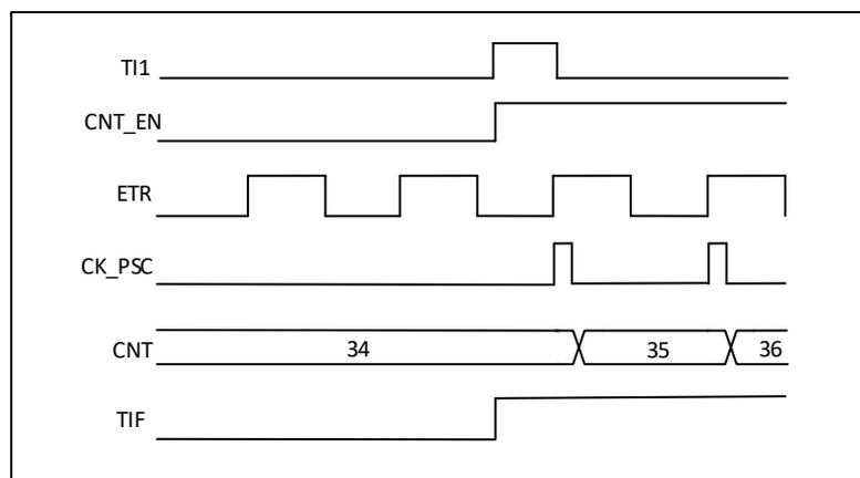
图 24-30 外部时钟模式2 + 触发模式下的控制电路
