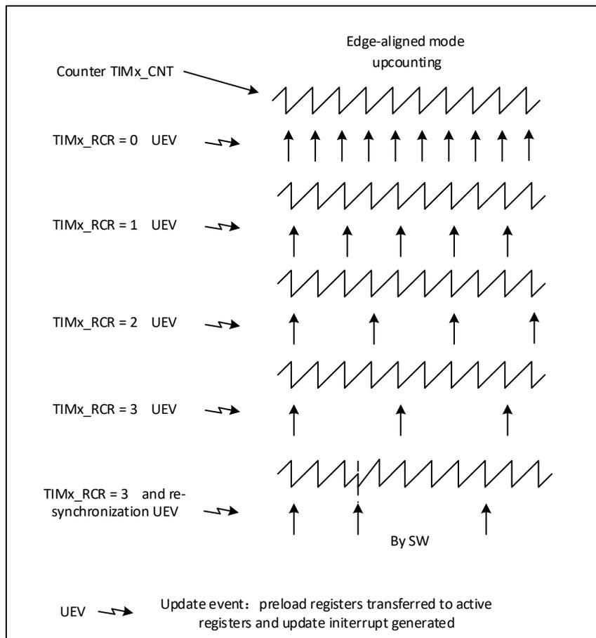
图 24-11 不同模式下更新速率的例子，及 TIMx\_RCR 的寄存器设置
