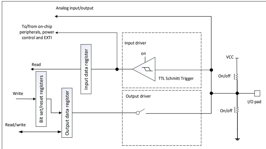
图 10-2 输入浮空/上拉/下拉配置
