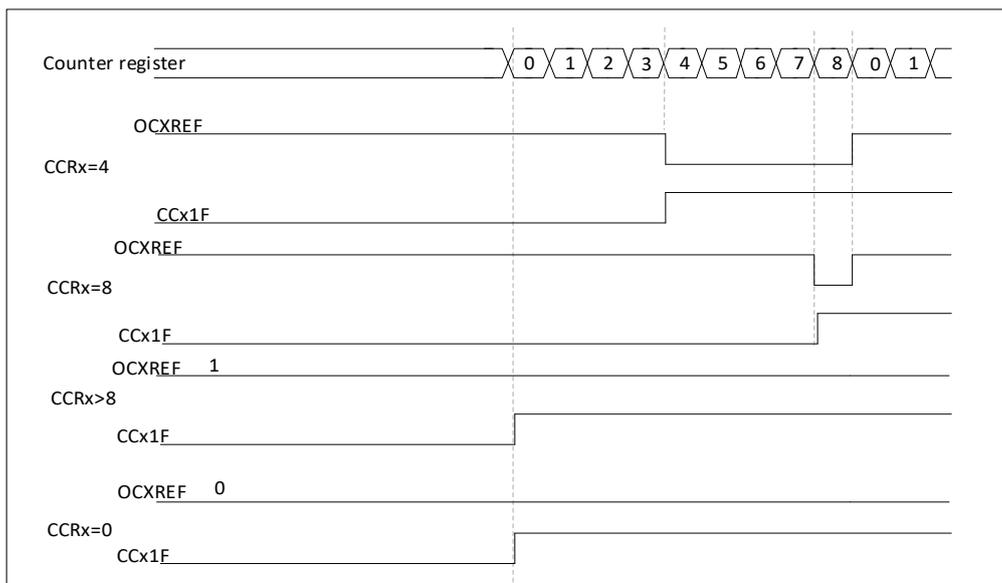
图 20-33 边沿对齐方式 PWM 输出，向上 (ARR=8)
