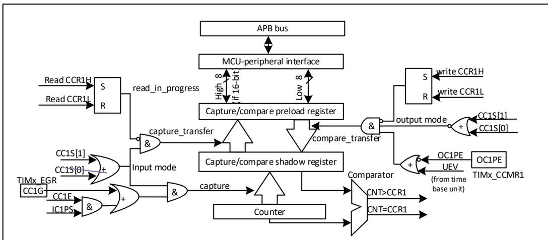
图 21-25 捕获/比较通道 1 的主电路
