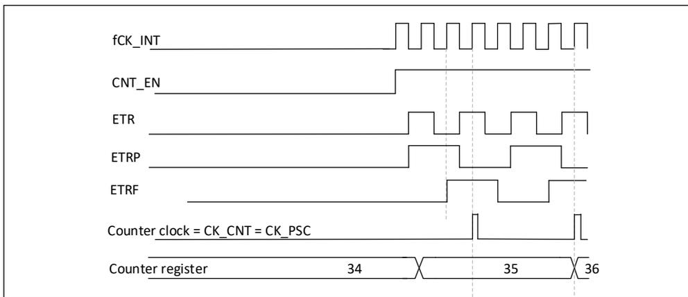
图 20-26 外部时钟模式 2 下的控制电路
