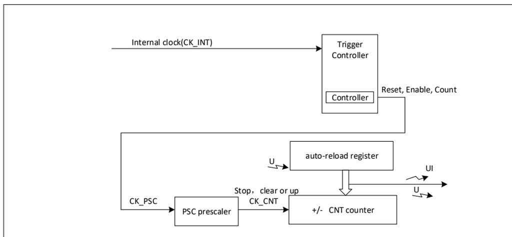
图 22-1 基本定时器架构框图
