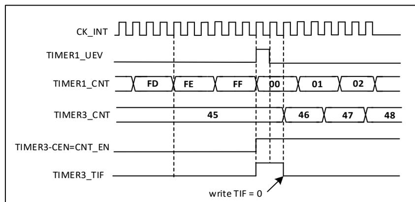
图 21-41 使用定时器 1 的更新触发定时器 3
