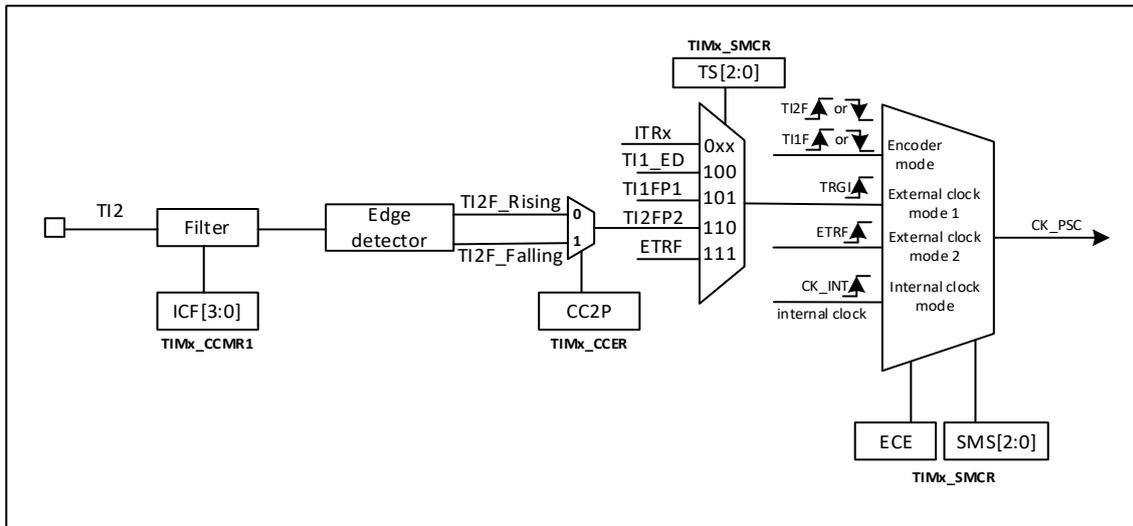
图 21-22 TI2 外部时钟连接示例
