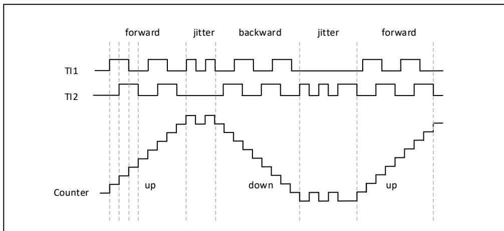
图 21-32 编码器模式下的计数器操作实例
