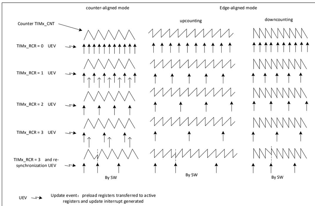
图 20-21 不同模式下更新速率的例子，及 TIMx\_RCR 的寄存器设置
