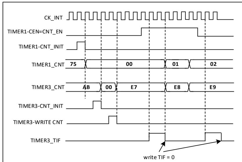
图 24-37 通过使能定时器1可以控制定时器2
