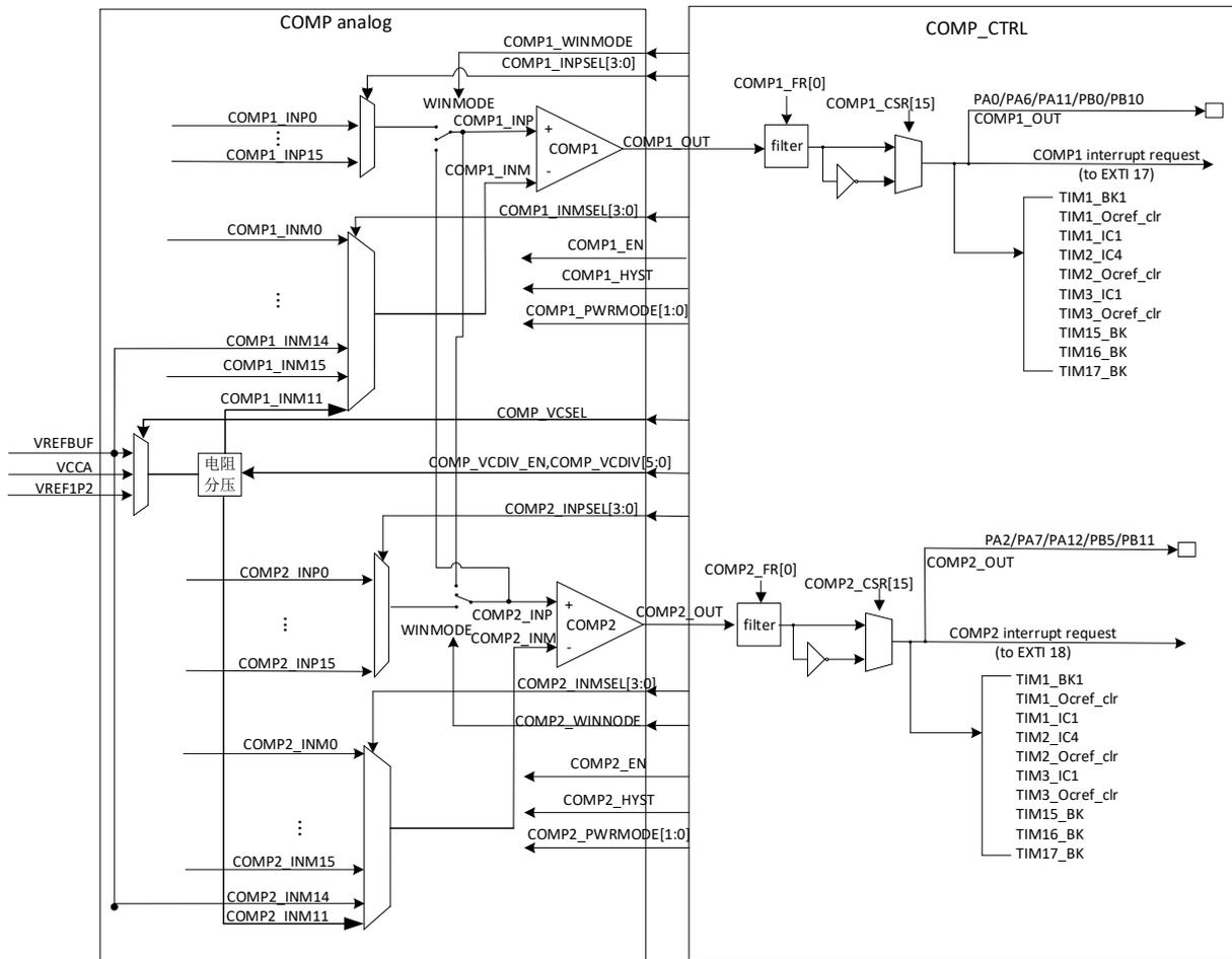
图 17-1 比较器架构框图
