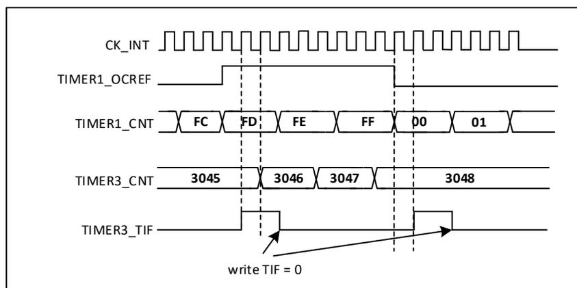
图 21-39 定时器 1 的 OC1REF 控制定时器 3
