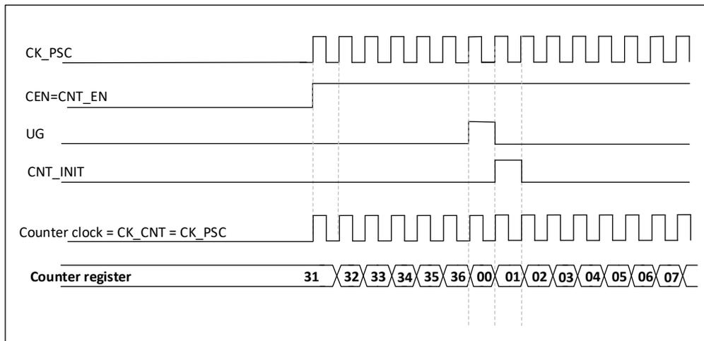
图 22-10 一般模式下的控制电路，内部时钟分频因子为 1
