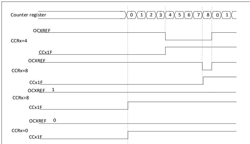
图 24-21 边沿对齐方式 PWM 输出，向上 (ARR=8)
