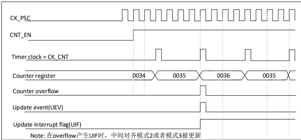
图 20-17 计数器时序图，内部时钟分频因子为 4，TIMx\_ARR=0x36
