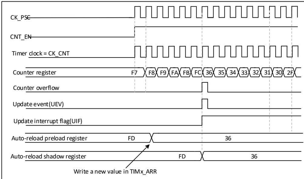
图 21-20 计数器时序图, ARPE=1 时的更新事件 (计数器上溢)
