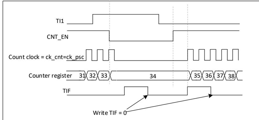
图 24-28 门控模式下的控制电路
