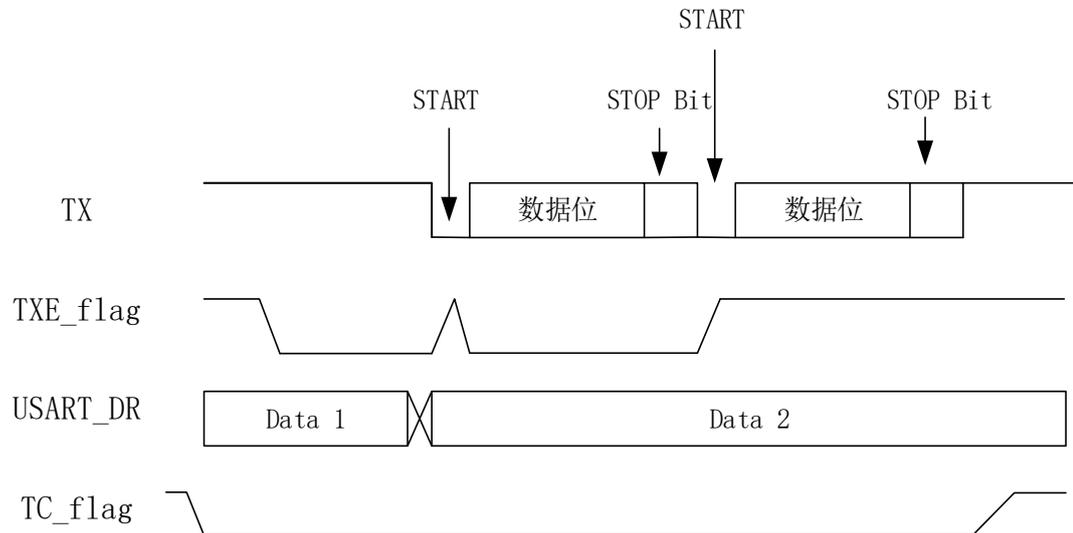
图 31-4 USART 发送时 TC/TXE 的变化
