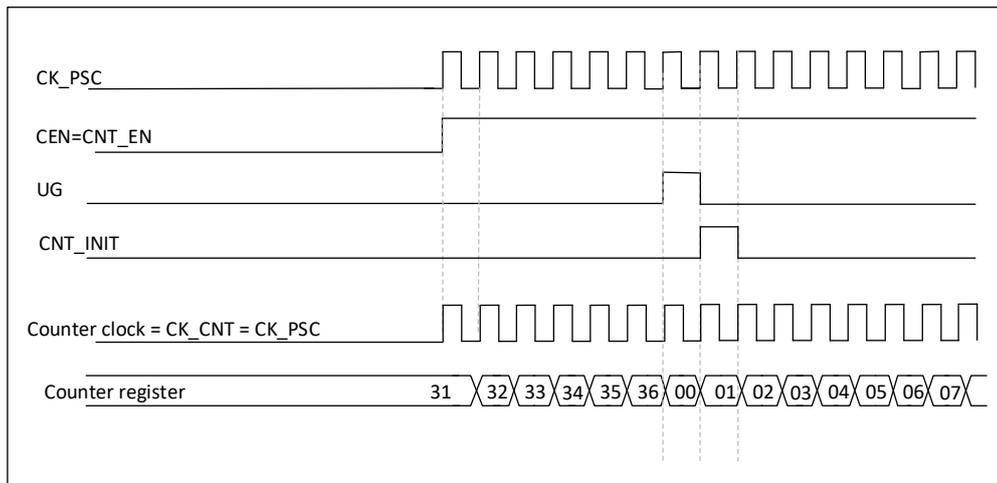
图 20-22 一般模式下的控制电路，内部时钟分频因子为 1
