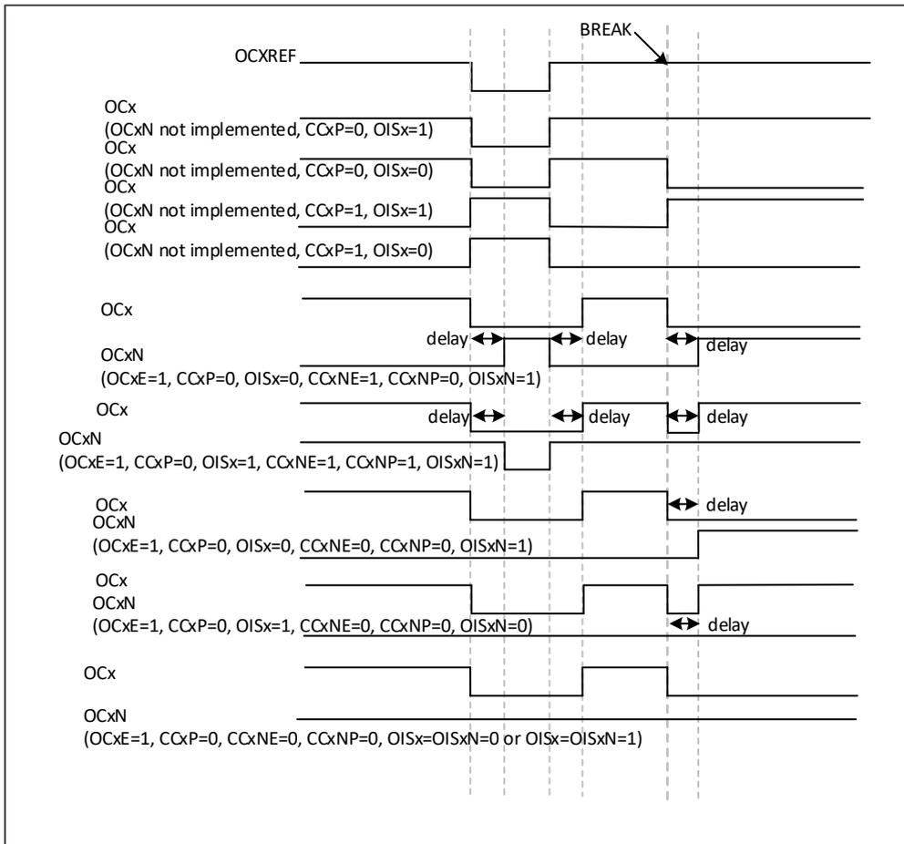
图 20-38 响应刹车的输出
