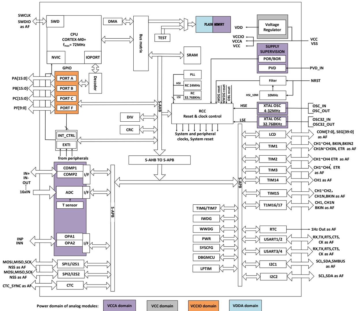
图 2-1 系统架构框图
