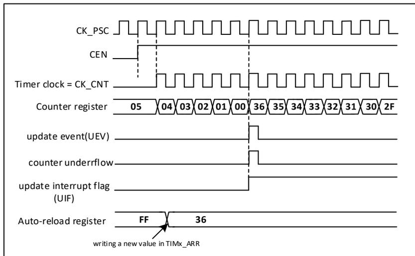
图 21-14 计数器时序图，当没有使用周期计数器时的更新事件
