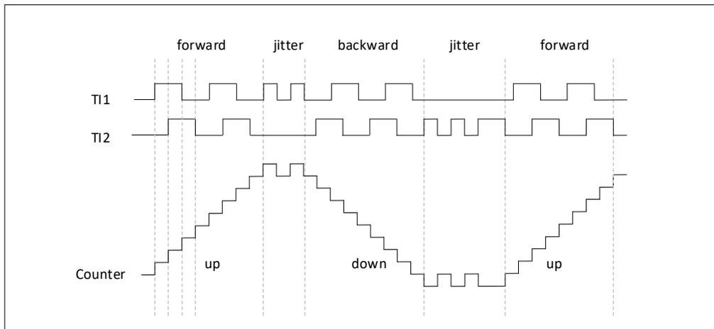
图 20-42 编码器模式下的计数器操作实例
