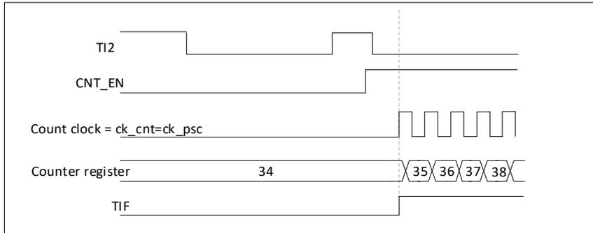
图 20-47 门控模式下的控制电路
