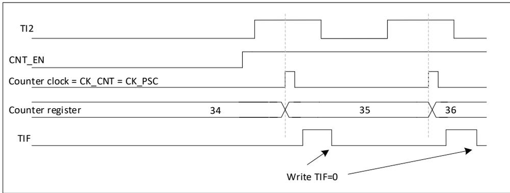
图 24-14 外部时钟模式1下的控制电路
