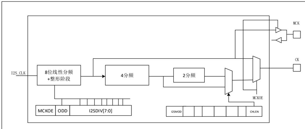
图 30-33 I2S 时钟发生器结构
