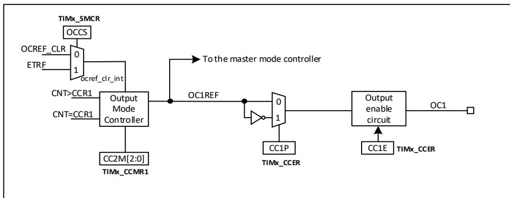
图 21-26 捕获/比较通道的输出部分 (通道1)
