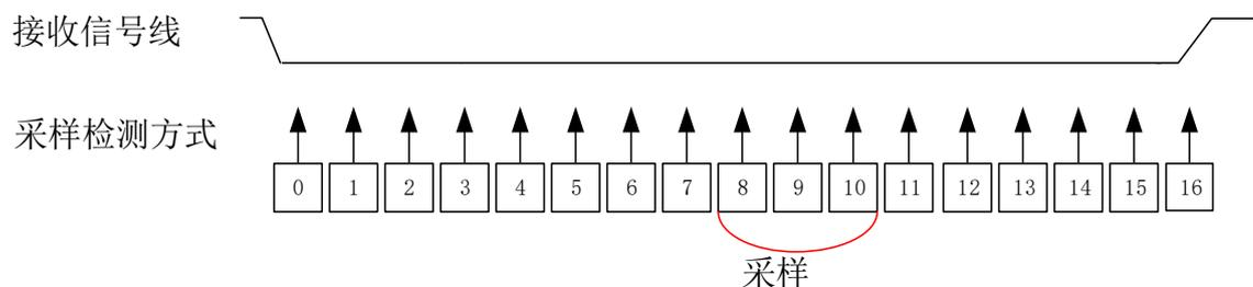
图 31-6 检测噪声的数据采样
