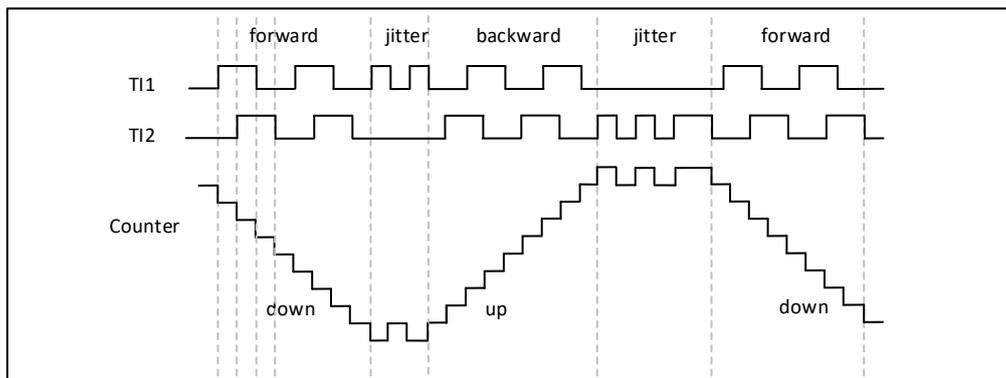
图 21-33 IC1FP1 反相的编码器接口模式实例
