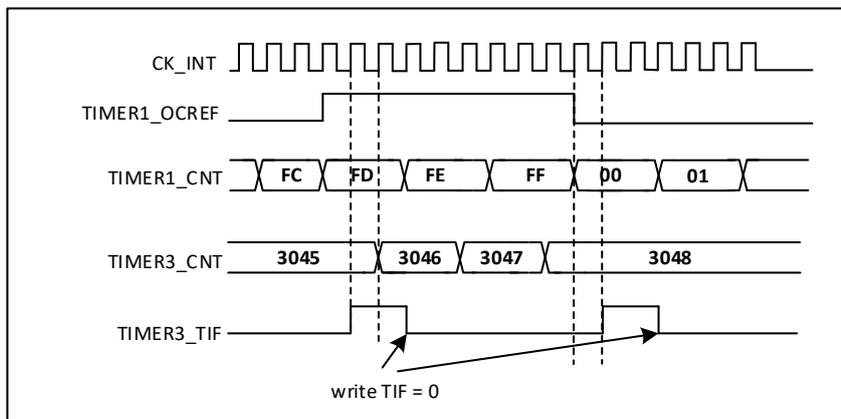
图 24-36 定时器1的 OC1REF 控制定时器2
