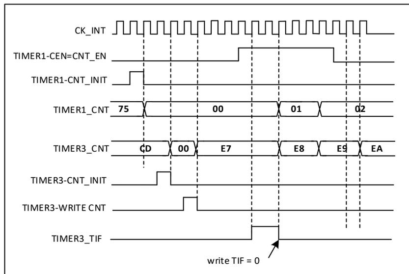
图 21-42 利用定时器 1 的使能触发定时器 3
