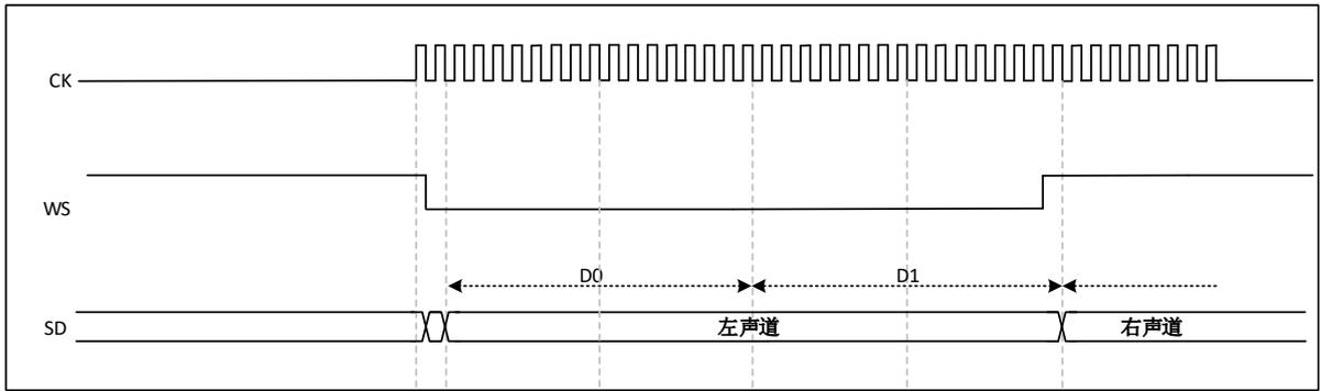
图 30-11 I2S 飞利浦协议波形 (16/32位全精度, CKPOL = 0)
