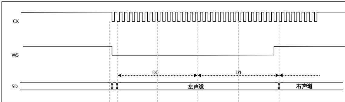
图 30-12 I2S 飞利浦协议波形 (16/32位全精度, CKPOL = 0)
