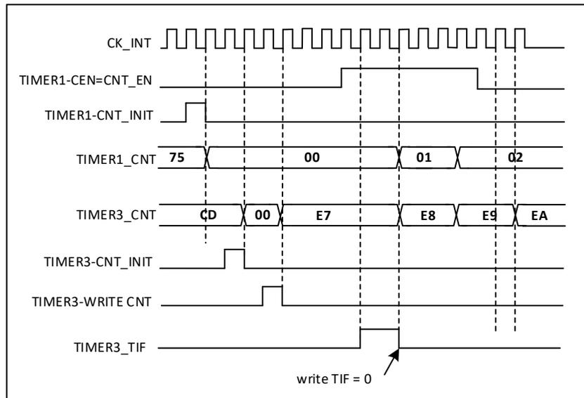
图 24-39 利用定时器1的使能触发定时器2
