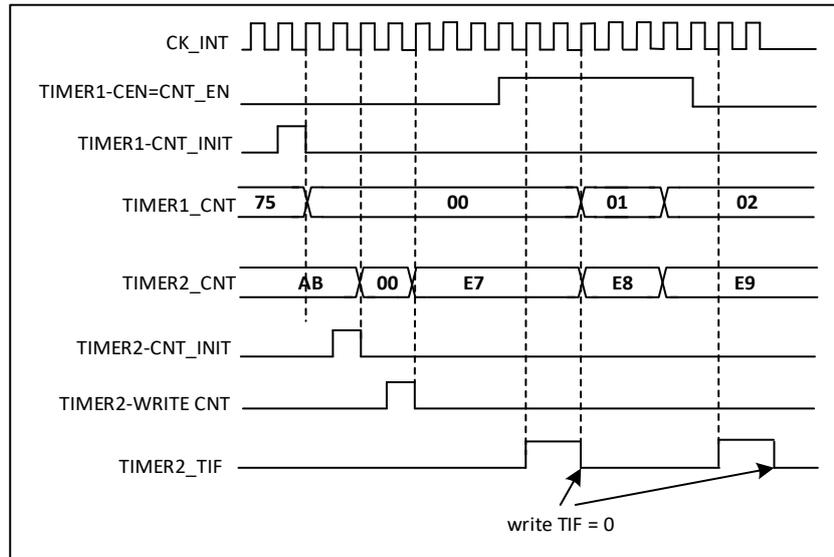
图 21-40 通过使能定时器 1 可以控制定时器 2
