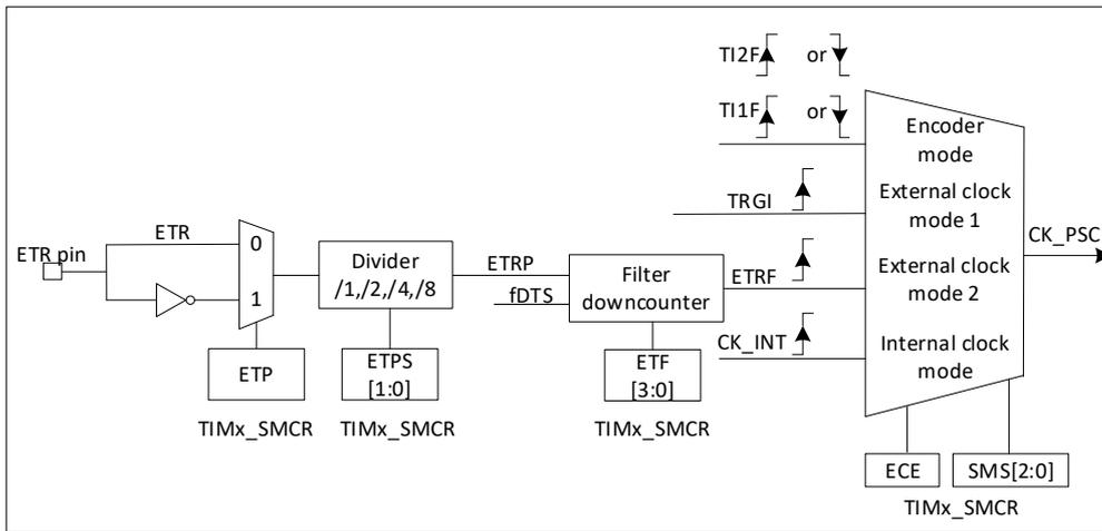
图 20-25 TI2外部触发输入框图
