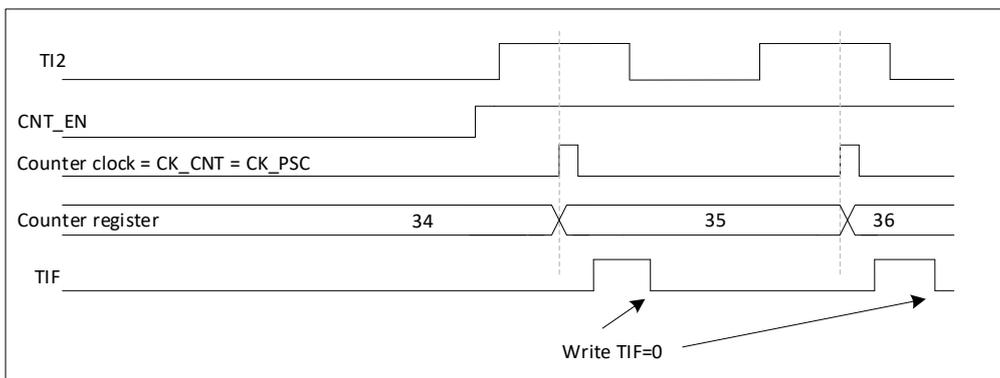
图 20-24 外部时钟模式 1 下的控制电路
