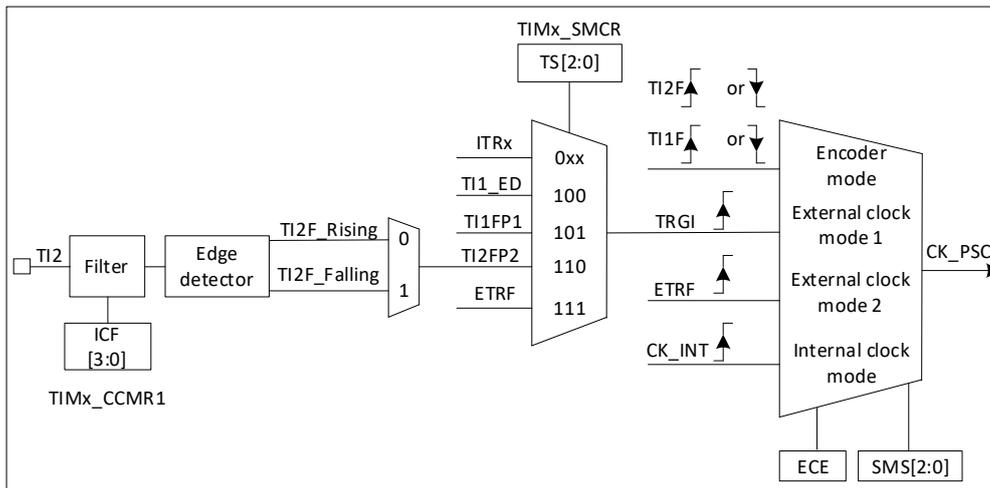
图 24-13 TI2 外部时钟连接例子
