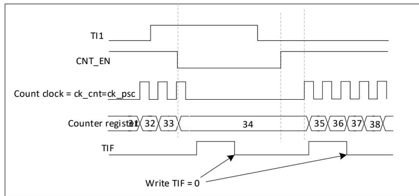
图 24-32 门控模式下的控制电路
