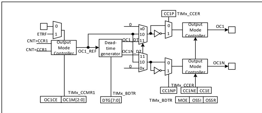
图 24-17 捕获/比较通道的输出部分（通道 1 至 3）
