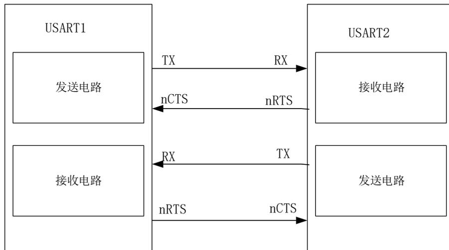
图 31-21 两个 USART 间的硬件流控制
