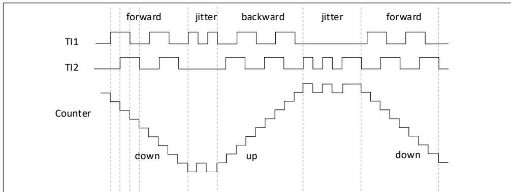
图 20-43 TI1FP1 反相的编码器接口模式实例
