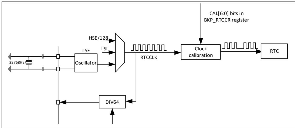
图 28-4 RTC 校准图
