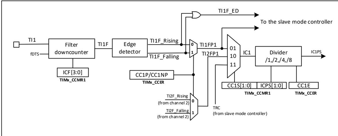
图 21-24 捕获/比较通道 (如: 通道 1 输入部分)
