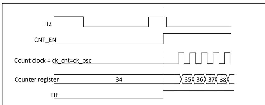
图 24-29 触发器模式下的控制电路
