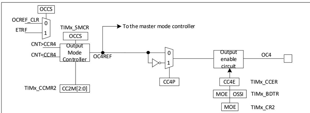
图 20-30 捕获/比较通道的输出部分 (通道 4)
