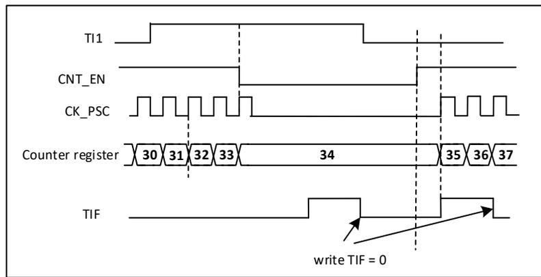
图 21-35 门控模式下的控制电路
