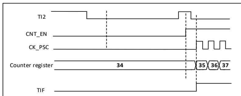
图 21-36 触发器模式下的控制电路
